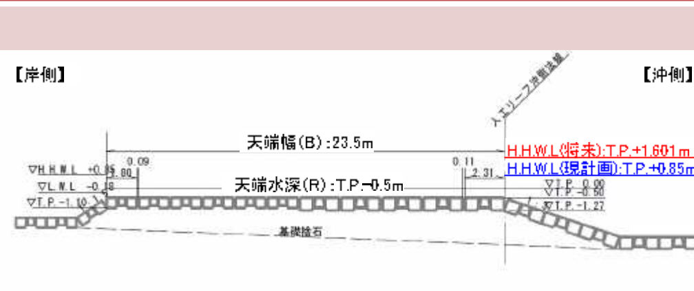
鳥取海岸・福部海岸 1号人工リーフ標準断面図
